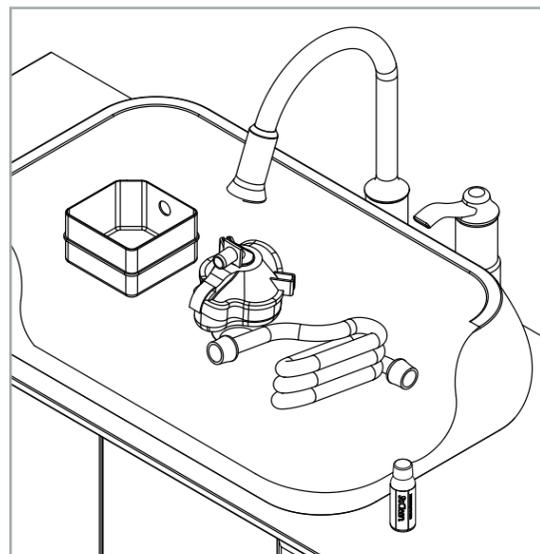
Se è presente un serbatoio, reinserirlo nella macchina PAP. Prima di ricollegare il tubo PAP, consultare le istruzioni di configurazione nel manuale utente del dispositivo SoClean. Se la macchina PAP richiede un adattatore, consultare le relative istruzioni per la configurazione.
