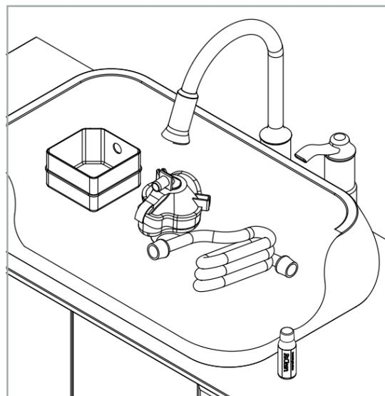
Si tiene un depósito, vuelva a insertarlo en el equipo de PAP. Antes de volver a colocar la manguera de PAP, consulte las instrucciones de montaje en el manual de usuario del dispositivo SoClean. Si su equipo de PAP requiere un adaptador, consulte las instrucciones del adaptador para el montaje.
