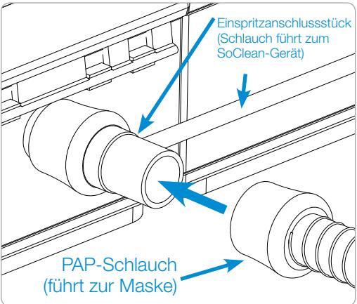
**Figure 3. Anschließen des PAP-Schlauchs an das Einspritzanschlussstück**
