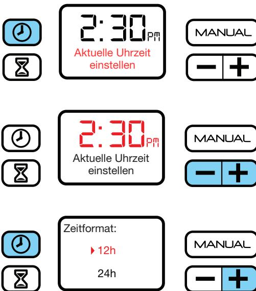
**ACHTUNG:** Stellen Sie nach einem Stromausfall im Haus oder einer Unterbrechung der Stromzufuhr zum SoClean 2-Gerät vor der Verwendung Ihres PAP-Geräts sicher, dass die korrekte Uhrzeit und Zyklus-Startzeiten eingestellt sind. Andernfalls nimmt das SoClean 2-Gerät den Betrieb möglicherweise zu einem unerwarteten Zeitpunkt auf.
